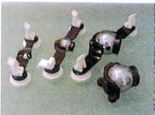
**Le Flat Offset Zéro « ventouse »** c'est le SMR en contact direct avec la surface à contrôler sur une surface lisse, plane ou galbée, compatible toutes marques de SMR, décliné en 1.5", 7/8" et 0.5".
