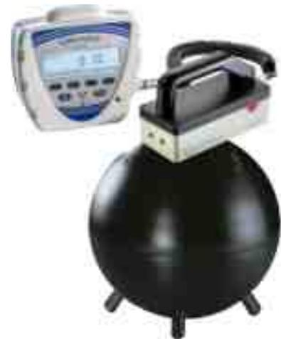
L'UMo II et sonde de débit d'équivalent de dose pour mesure du rayonnement neutronique ambiant H\*(10)
