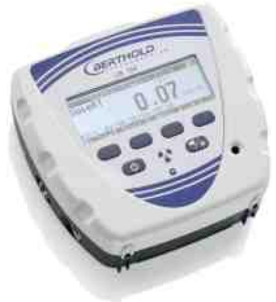
L'UMo II seul permet la mesure de débits d'équivalent de doses gamma H\*(10)
