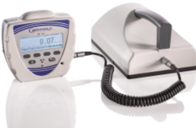
L'UMo II et sonde de mesure de la contamination surfacique utilisable en portable et/ou semi-stationnaire grâce à un jeu de supports muraux.
