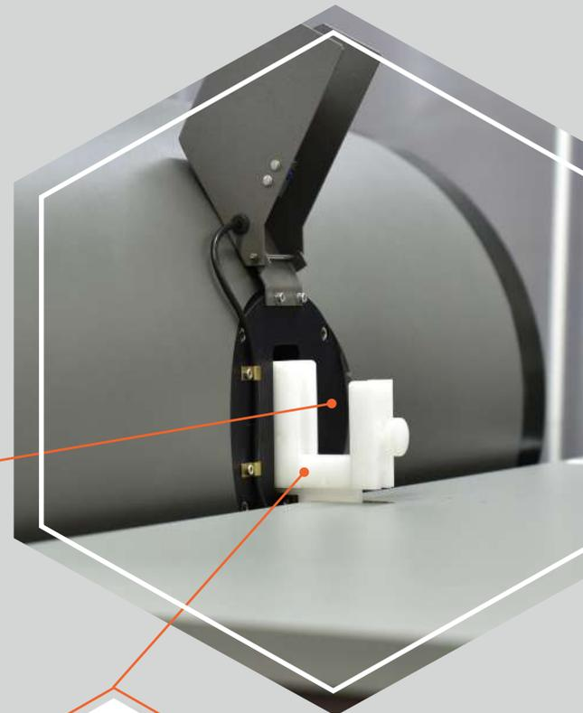
Les échantillon testés sont des **alliages métalliques** : (par ex carbures cémentés, aciers martensitiques, composites à aimantation douce, ou aimants) dont la **mesure de phase magnétique est importante**.
