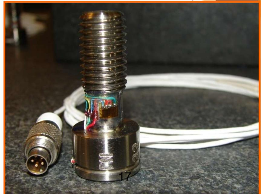
Mesure de tension dans les assemblages vissés
