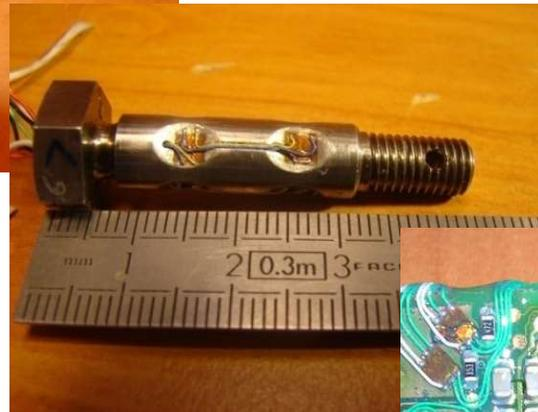
Axe dynamométrique miniature bi-direction
