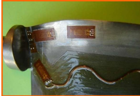
Jauges de déformations et cheminement pour essai de calibration
