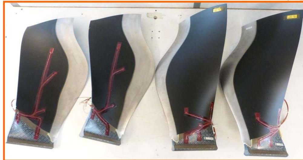
Jauges de déformations et cheminements pour essai sur banc
