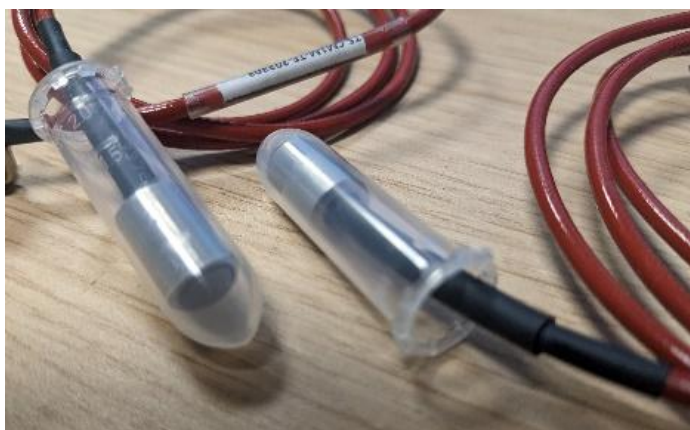
Fig.1 Exemple de capteur de la Série DHF : fluxmètre total avec interface à corps lisse
